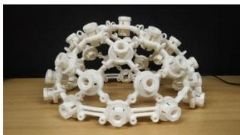
Рисунок 5 — Каркас для подключения датчиков электроэнцефалографа
